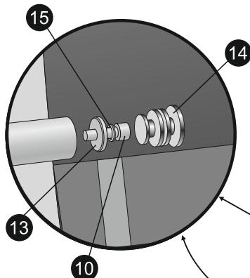
Для удобства воспользуйтесь специальным ключом для предварительного закручивания винта 10 в подлокотник. Затем ключом тую затяните винт 10, покачивая подлокотник.
